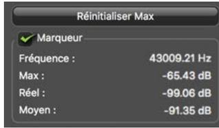
La fréquence et les niveaux de bruit (dB) à l'emplacement du pointeur de la souris sont affichés sous **Marqueur**.
